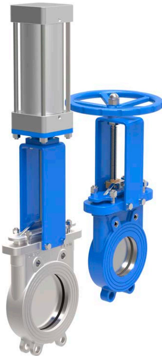
\* Указанные давления должны применяться к задвижке по направлению, указанному стрелкой на корпусе. Конструкция шиберной задвижки с опорными направляющими ножа устроена таким образом, что позволяет удерживать до 30% указанного давления в направлении, противоположном направлению стрелки на корпусе задвижки так называемое обратное давление.
