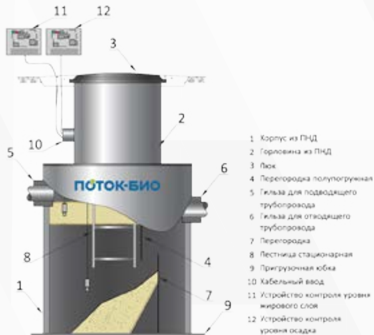
Рис. 15 Конструктивная схема жиросепаратора «Поток ЖУ»
