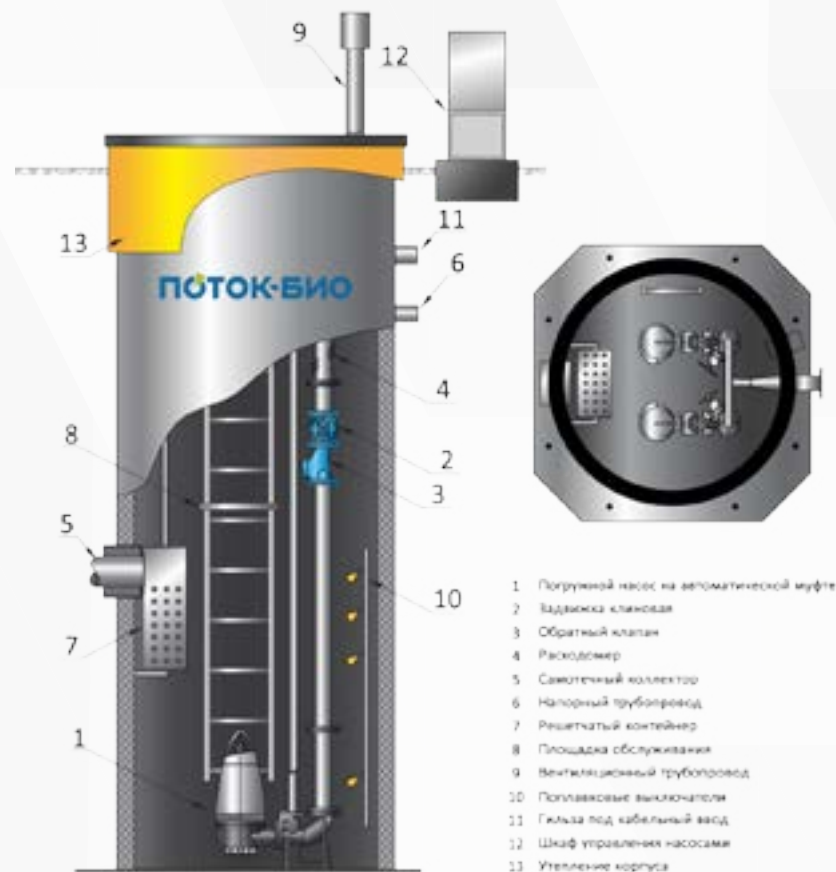
Рис. 2 Конструктивная схема блочной КНС «Поток»
