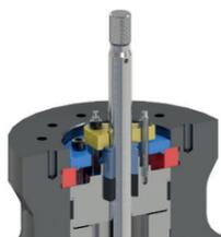
Хорошее уплотнение горловины клапана
